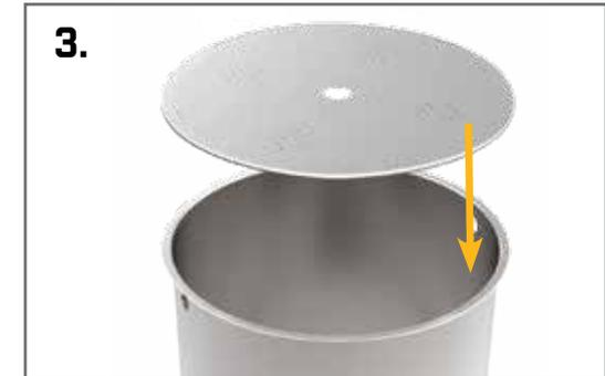
Drücken Sie das untere Lochblech (42) durch den Innenkorb (34). Drücken Sie auf die Ränder, um sicherzustellen, dass es waagrecht ist. **ACHTUNG:** Drücken Sie fest zu, die Passform ist absichtlich eng. Befeuchten Sie das Innere des Korbs, damit das Silikonsiegel nicht hängenbleibt und das Blech einfacher einzupassen ist.
