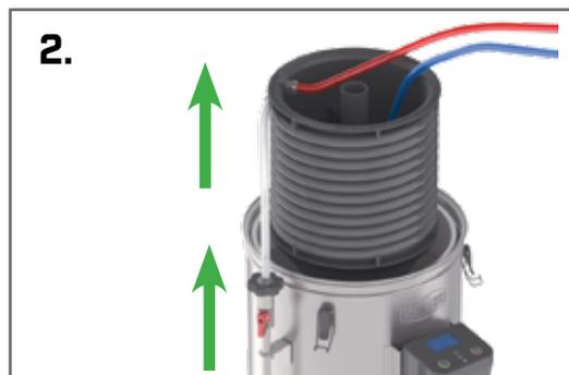
Verbinden Sie den Gegenstromwürrkühler nach Anleitung. Stellen Sie 55°C (131°F) ein. Platzieren Sie den 'Kaltwürzeablaufschauch' (Verbindung D) des Kühlers am Loch im Glasdeckel und lassen Sie den Reiniger 5 Minuten durchlaufen.
